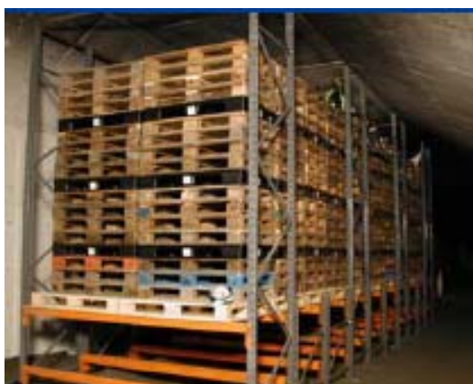
Slika 8.3. Maketa tereta HGV u testu T1 Runehamar, prije i nakon testa [279]
