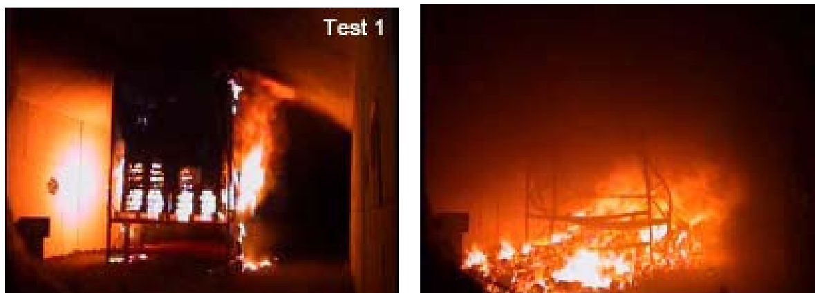
Slika 8.4. Maketa tereta HGV u testu T1 Runehamar, 5 min (lijevo) i 30 min (desno) nakon početka gorenja, Brekelmans i v.d. Bosch [279]
