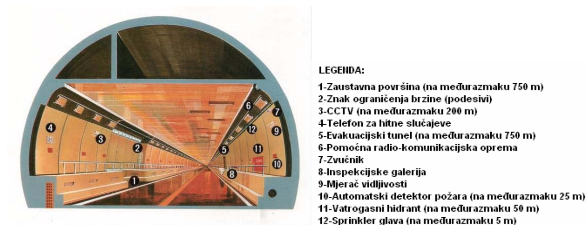
Slika 3.6. Primjer japanskog tunela klase AA opremljenog sigurnosnim uređajima i instalacijama [91]
