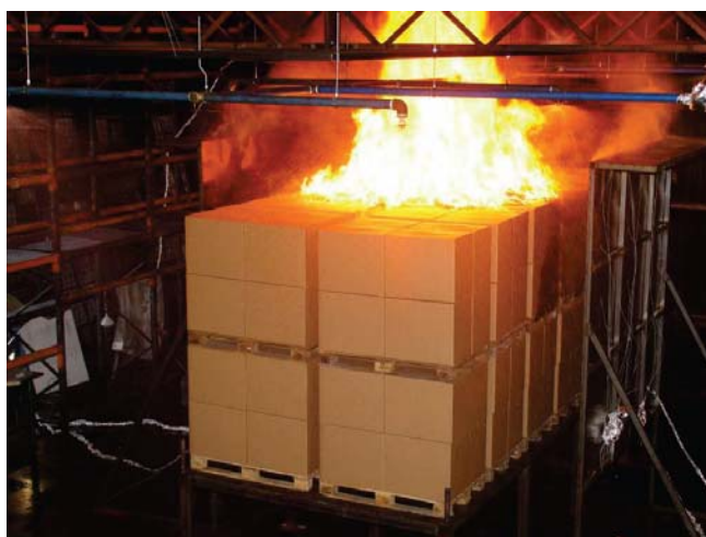
Slika 6.8. Žarište u trenutku aktiviranja FFFS (test bez pokrova na maketi žarišta) [106]
